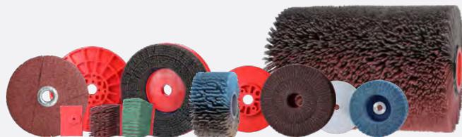
この加工工程では、一次バリおよび二次バリを除去し丸み付けが行われます。その後の処理工程（粉体塗装、湿式塗装、電気めっき、陽極酸化処理等）のための条件を整え、鋭利なエッジによるケガの恐れを防止するために、しばしば一次バリ・二次バリの除去は、いわゆる丸みつけと組み合わせて処理されます。丸みつけの範囲は、数分の1 mm から2mm またはそれ以上の半径にわたります。今日、これらの半径はDIN EN 1090によって定められています。
