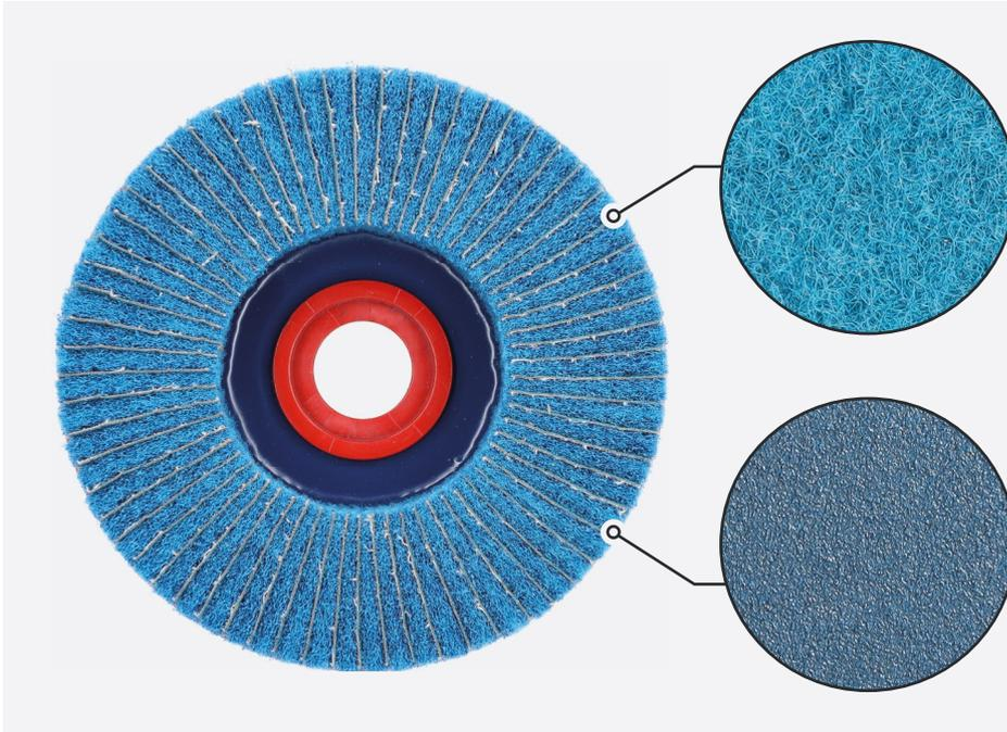
Das blaue, harte Schleifvlies presst das Zirkonkorund-Schleifgewebe sehr stark an die zu entgratenden Kanten und führt so zu einer starken Kantenverrundung.
